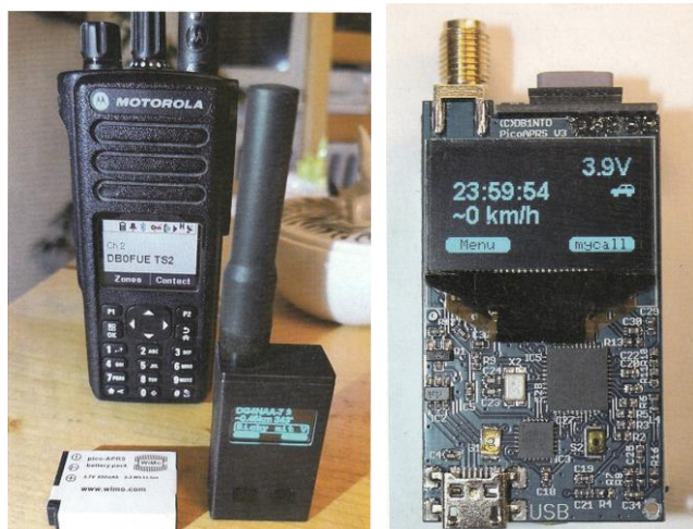
Fot. 7.1. Porównanie wielkości PicoAPRS i ręcznej radiostacji Motoroli. Obok widoczny jest zapasowy akumulator
