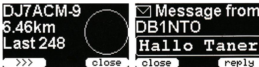
Rys. 7.6. Obliczona odległość między stacjami
