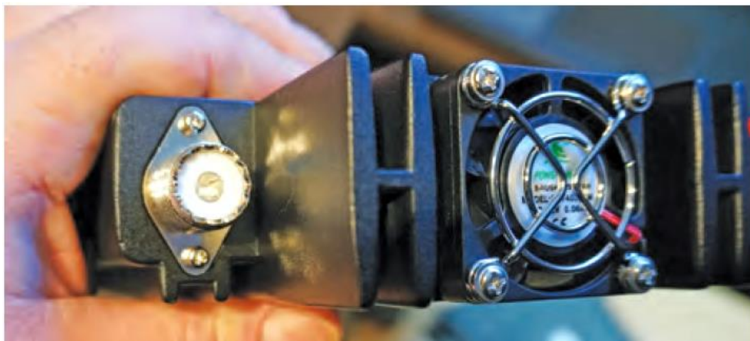
Fot. 8.2. Radiostacja posiada jedno gniazdko antenowe wspólne dla wszystkich pasm. Gniazdko głośnikowe, odbiornika GPS i kabel zasilający znajdują się po drugiej stronie wentylatora
