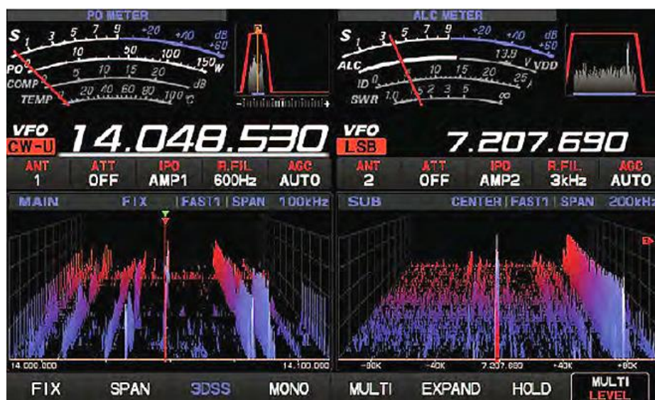
Fot. 1.3. Widok jak z fot. 1.2, ale po dodaniu wskaźnika perspektywnego dla pomocniczego odbiornika, który może być dostrojony do innego pasma, nastawiony na odbiór innej emisji i połączony z inną antena niż główny. Wskaźniki obu odbiorników można też umieścić jeden nad drugim
