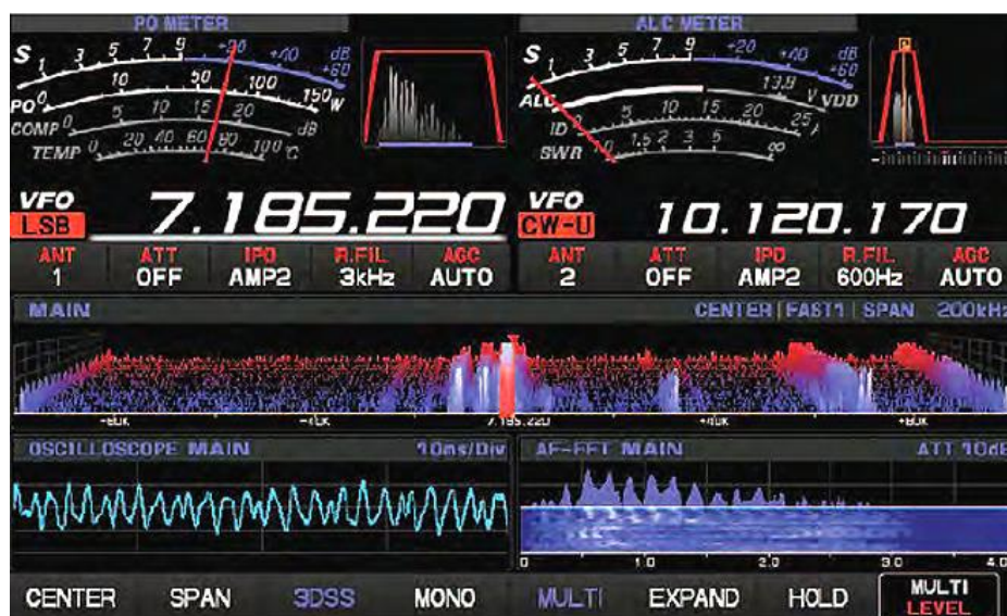
Fot. 1.4. Na wskaźniku widoczne jest widmo pasma 40 m, a poniżej widmo m.cz. odbieranego sygnału i jego przebieg oscyloskopowy
