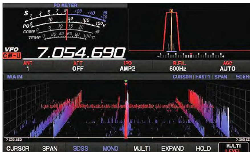
Fot. 1.2. Ten sam podzakres po włączeniu wskaźnika trójwymiarowego. Zastępuje on zwykły wskaźnik wodospadowy. Trzecim wymiarem jest czas, którego oś przebiega perspektywicznie w głąb wskaźnika.
