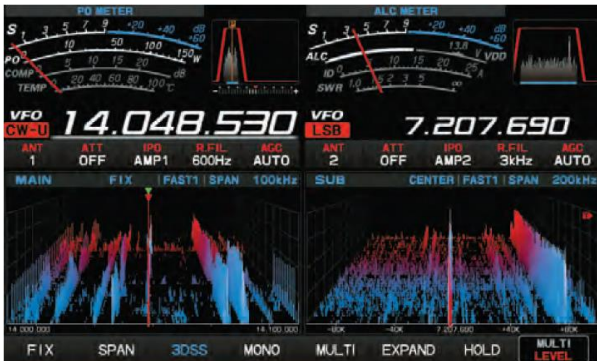
Fot. 3.4. Wskaźniki widma dla obu odbiorników (głównego i pomocniczego) równoległe. Odbiornik pomocniczy jest nastawiony na inne pasmo, inną szerokość pasma i korzysta z innej anteny. Oba widma mogą być też wyświetlane jedno nad drugim
