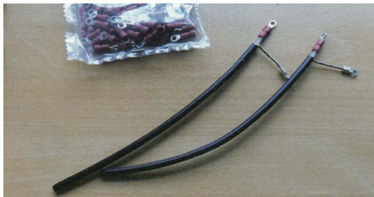
Fot. 1.3.2. Wykonanie kondensatorów koncentrycznych
