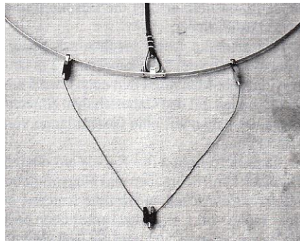
Fot. 1.7.4. Transformator delta
