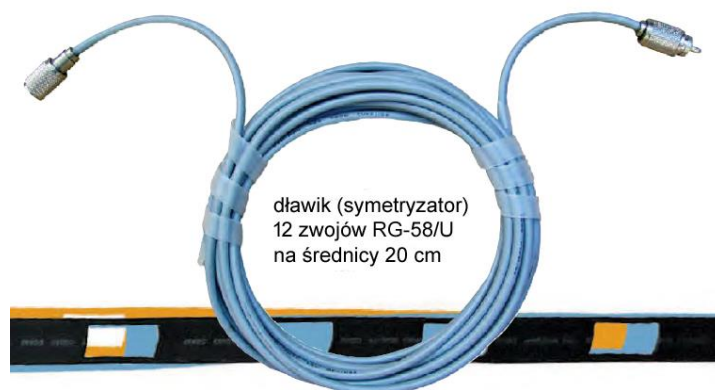
Fot. 2.4.2. Symetryzator ze zwiniętego kabla koncentrycznego
