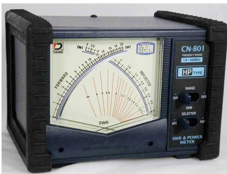
Rys. 2.1.8. Reflektometr ze skrzyżowanymi wskazówkami. Wartość WFS jest odczytywana na czerwonych rozchodzących się gwiazdźście liniach, bez konieczności kalibracji w miejscu skrzyżowania wskazówek. Równolegle na skalach odczytywane są moce fali padającej (podpis: FORWARD ) i odbitej (podpis: REFLECTED ). W pozycji przełącznika AVG mierzona jest średnia moc nadawanego sygnału, a w pozycji PEP – moc szczytowa. Reflektometry tego typu nie wymagają opisanej powyżej kalibracji
