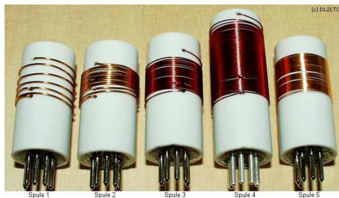
Fot. 3.1.5. Wykonanie cewek w konstrukcji „QRP Project”. Cewka 1 pokrywa zakres 19,9 – 40,1 MHz, 2 – 10,2 – 20,2 MHz, 3 – 5,3 – 10,5 MHz, 4 – 2,7 – 5,4 MHz i 5 – 1,4 – 2,8 MHz
