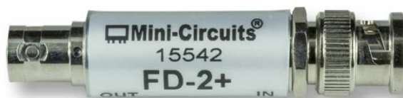
Fot. 4.9.3. Bierny podwajacz FD-2 pracuje w zakresie 10 – 1000 MHz i jest wyposażony w gniazdo i wtyk BNC 50 \Omega . Moce wejściowe leżą w zakresie 1 – 15 dBm, a straty przemiany wynoszą 13,5 dB
