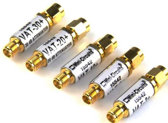
Fot. 4.0.15. Zestaw tłumików koncentrycznych firmy „Mini-Circuits” składa się z tłumików 3, 6, 10, 20 i 30 dB wyposażonych w złącza SMA lub BNC. Dopuszczalne moce wejściowe dla tłumików 3 – 10 dB wynoszą 1 W, a 20 i 30 dB – 0,5 W. Ich górna częstotliwość graniczna wynosi 6 GHz dla tłumików SMA i 2 GHz dla BNC
