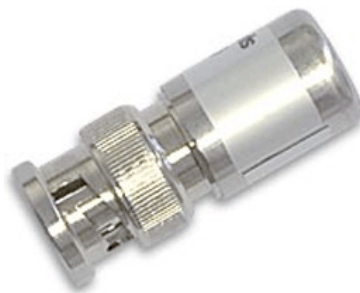
Fot. 4.0.15. Zestaw tłumików koncentrycznych firmy „Mini-Circuits” składa się z tłumików 3, 6, 10, 20 i 30 dB wyposażonych w złącza SMA lub BNC. Dopuszczalne moce wejściowe dla tłumików 3 – 10 dB wynoszą 1 W, a 20 i 30 dB – 0,5 W. Ich górna częstotliwość graniczna wynosi 6 GHz dla tłumików SMA i 2 GHz dla BNC
