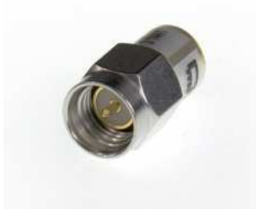
Fot. 4.0.16. Sztuczne obciążenie SMA na zakres do 18 GHz i dopuszczalnej mocy 1 W
