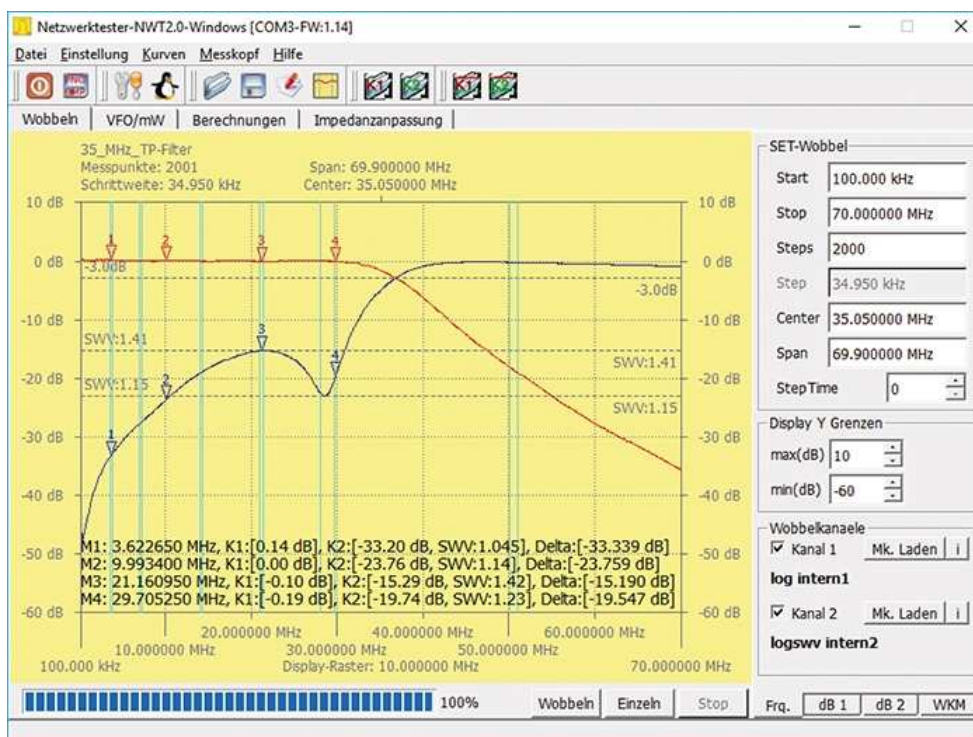
Rys. 4.0.11. Wyniki pomiarów S_{11} i S_{21} w oknie programu sterującego dla PC opartego na wcześniejszych wersjach dla NWT7 i 9
