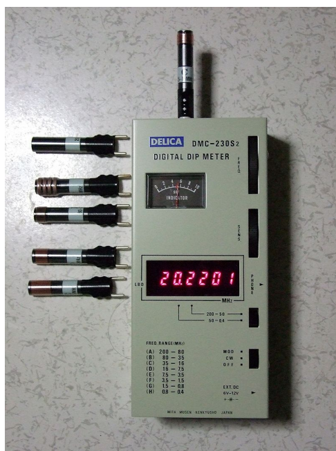
Fot. 3.0.3. Nowoczesny miernik z cyfrowym czestościomierzem
