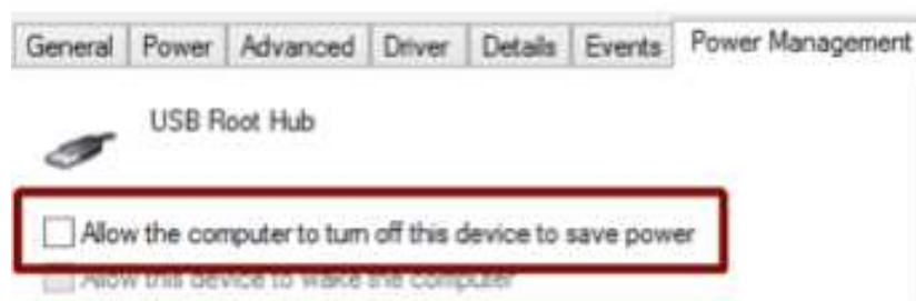
Rys. 6.2. Włączanie i wyłączanie trybu oszczędzania energii dla urządzeń USB
