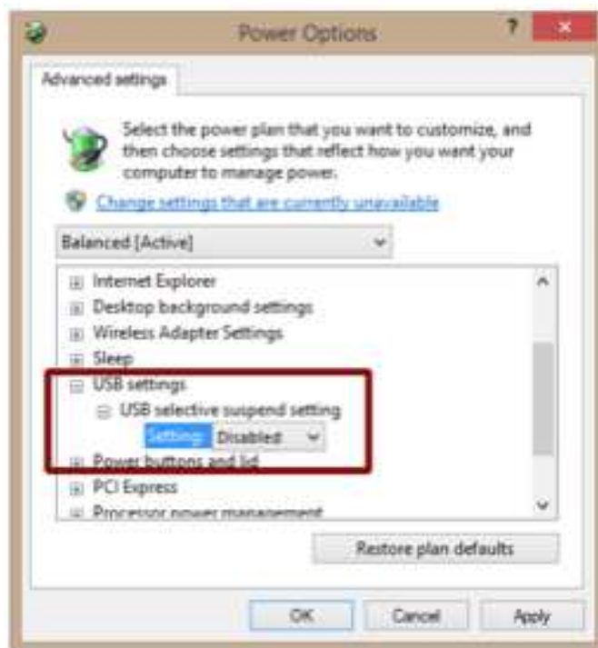
Rys. 6.3. Funkcja oszczędzania energii dla USB w panelu sterowania
