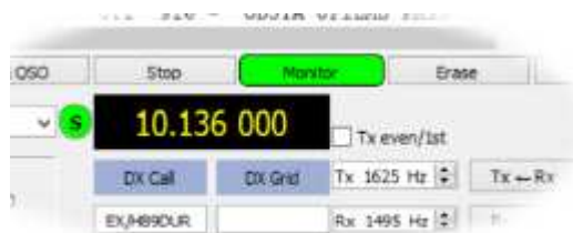
Rys. 3.5. Sygnalizacja oddzielnych częstotliwości nadawania i odbioru („Split”)
