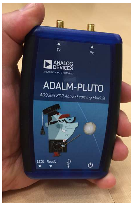
Fot. 2.13. TRX z cyfrową obróbką sygnałów „Pluto”
