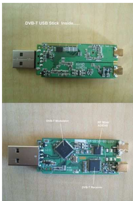
Fot. 2.22. Konstrukcja wewnętrzna. W górnej części nadajnik i syntezer na AD 8345, u dołu odbiornik
