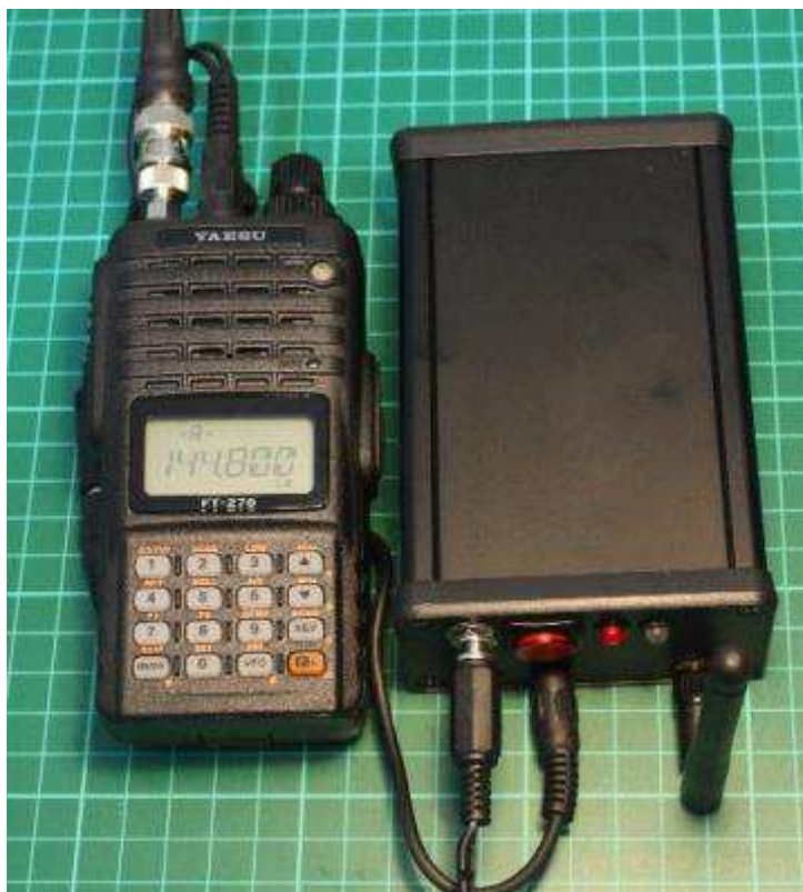
Rys. 2.3. Konstrukcja bramki z radiostacją ręczną
