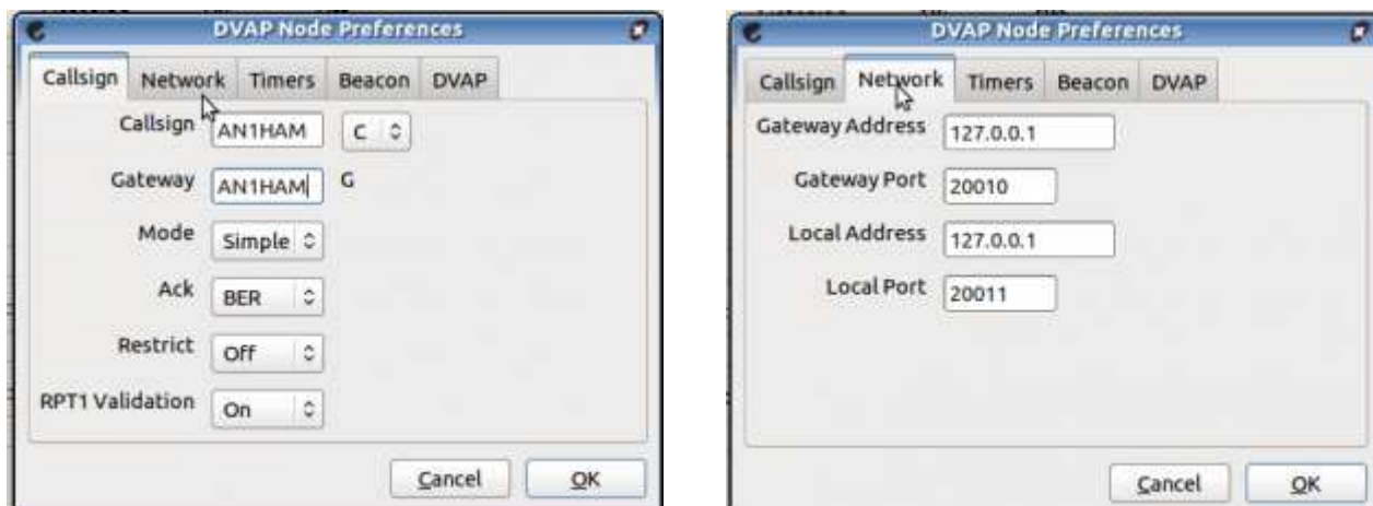
Rys. 3.11ab. Pierwsze dwie zakładki konfiguracji „DVAP Node“. W polach „Callsign“ („Znak“) i „Gateway“ („Bramka“) należy podać własny znak wywoławczy i do pierwszego z nich wybrać literę odpowiadającą pasmu pracy – zgodnie z ogólnie przyjętymi zasadami. Tryb pracy pozostaje simpleksowy. Pole „Restrict“ decyduje o ograniczeniu dostępu dla innych użytkowników.
