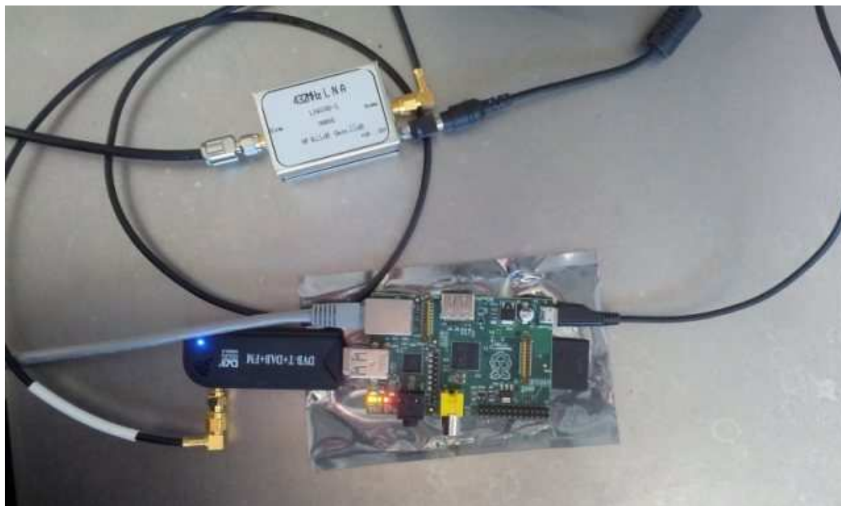
Rys. 5.4. Po dodaniu przedwzmacniacza możliwy jest odbiór satelitów amatorskich
