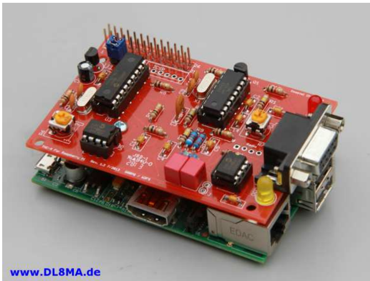
Rys. 2.8. Miniaturowy modem TNC-2 dla „Maliny”
