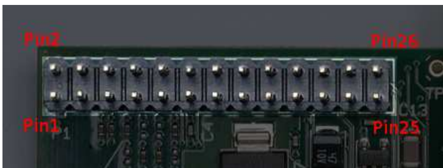
Rys. 1.5b. Numeracja kontaktów na złączu GPIO i jego położenie. Nóżki o numerach 1 i 2 znajdują się najbliższej krawędzi płytki
