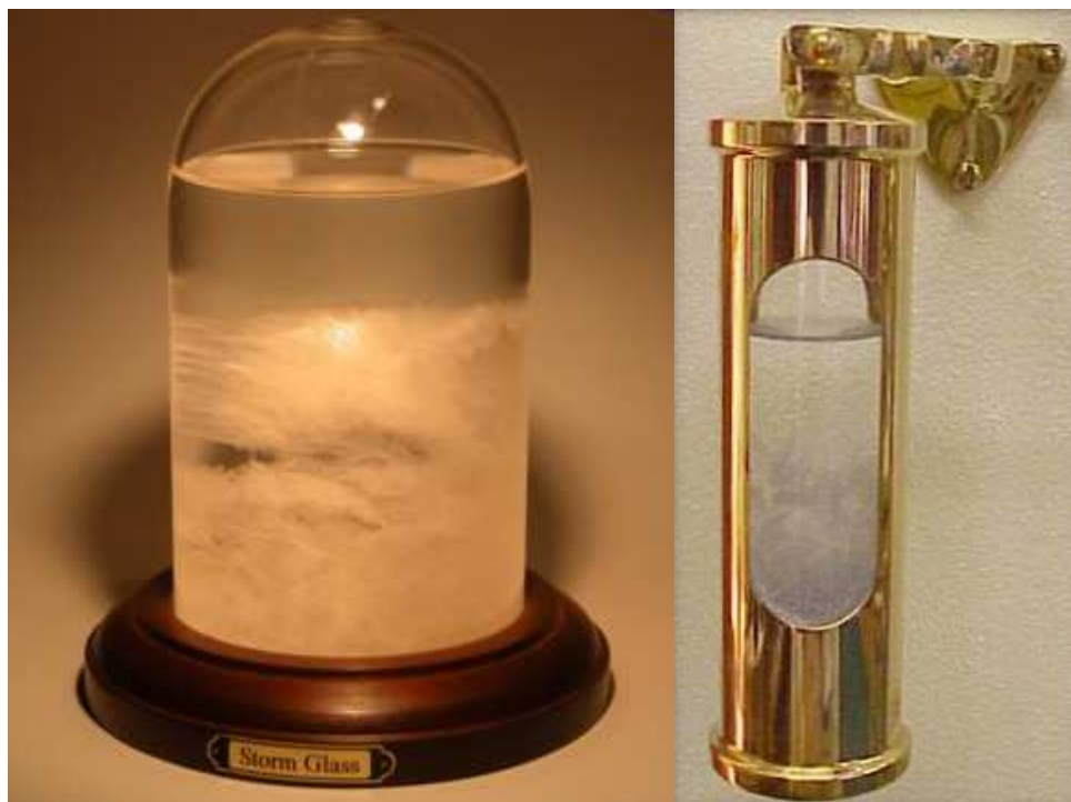
Przykłady rozwiązań współczesnych barometrów chemicznych. Źródło: internet.
